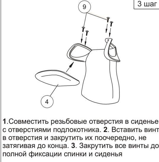
1. Совместить резьбовые отверстия в сиденье с отверстиями подлокотника. 2. Вставить винты в отверстия и закрутить их поочередно, не затягивая до конца. 3. Закрутить все винты до полной фиксации спинки и сиденья
